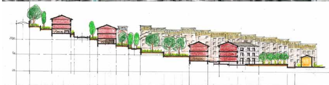
Coupe transversale du projet : appropriation du relief par un aménagement en palier (principe à respecter)
