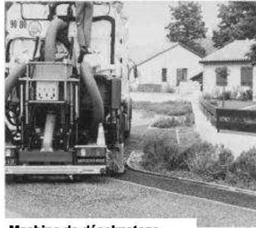
Machine de décolmatage. Source CETE du Sud-Ouest
