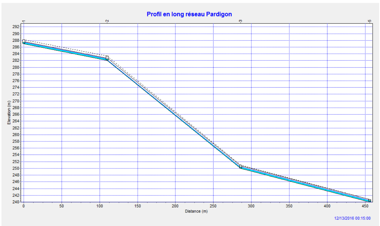
Figure 13 : Profil en long de la future collecte des eaux pluviales – quartier Pardigon
